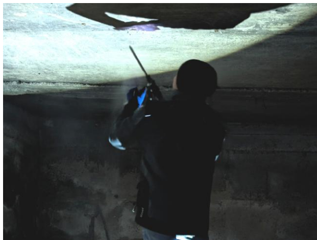
10 pav. Pasitikrinimui ardančiuoju metodu atidengta rūsio perdangos plokštės armatūra.
